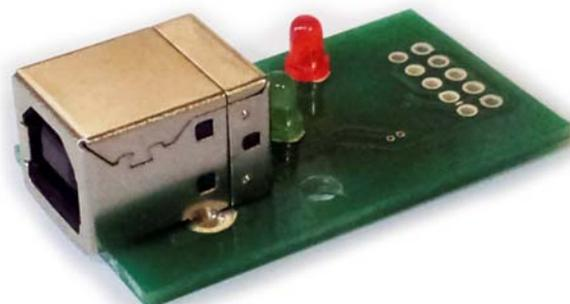
Переходник предназначен для подключения различных устройств, имеющих UART (USART) универсальный асинхронный приёмопередатчик к персональному компьютеру или устройству, имеющему в своем составе USB HOST. Переходник оснащен разъемом USB – B, что облегчает встраивание переходника в собственные изделия. У устройства можно изменять серийный номер, что позволяет подключить несколько устройств к одному персональному компьютеру.
